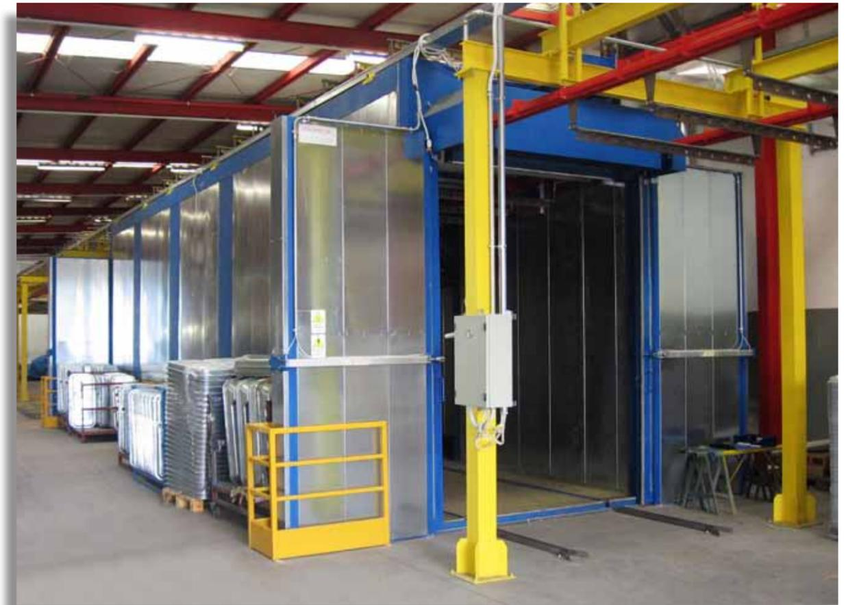
Forno di essiccazione vernice con porte automatiche
